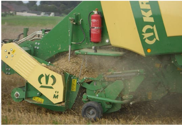
Vorbauhäcksler PreChop von Krone: Das Gerät arbeitet wie der Häcksler eines Mähdreschers und bläst das Stroh in die Presse. Das Stroh wird zusätzlich aufgefasert, was Oberfläche weiter vergrößert.
