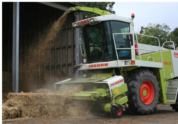
Beim Häckseln der Ballen staubt es stark. Die Zerkleinerungsqualität bewegt sich im Bereich des Vorbauhäckslers.
