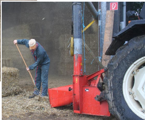
Strohmühle mit 30 mm-Sieb: Die Zerkleinerung ist gut, allerdings staubt es stark und der Arbeitsaufwand ist hoch.
