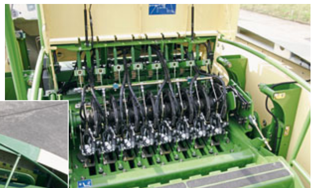
Die 8 Rassepe-Doppelknoter wurden komplett neu entwickelt und sind 5 cm schmalere. Auf Wunsch sorgen zwei mechanisch angetriebene Radialgebläse zusätzlich zur Druckluftreinigung für mehr Bindsicherheit.
