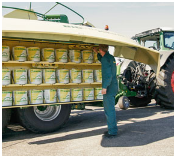
2 x 27 Rollen können in den hydraulisch (!) absenkbaren Kästen untergebracht werden.
