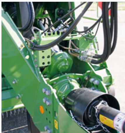
Das Zwischengetriebe sorgt für einen gradlinigen Kraftverlauf und hat eine integrierte hydraulische Anlaufhilfe. Außerdem wird die Drehzahl von 1000 auf 1180 U/min erhöht.
