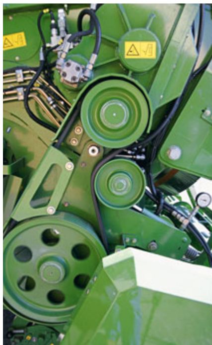
Der Rotor samt Pickup wird per Keilriemen angetrieben und kann separat zugeschaltet werden. Über den Schlupf wird die Auslastung kontrolliert.
