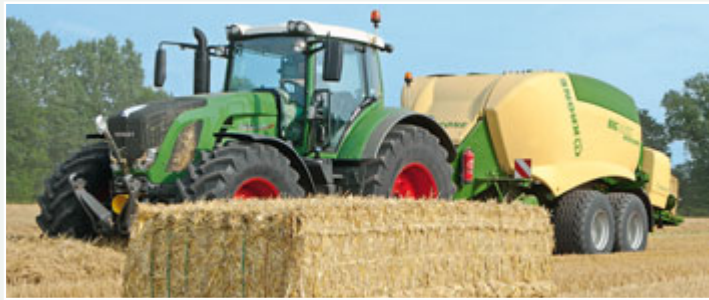
Der Fendt 939 mit 390 PS fuhr bei dem Leistungstest mit der HDP II auf dem 800 m langen Schlag rund 15 km/h. So fiel etwa alle 23 Sekunden ein 2,40 m langer und fast 500 kg schwerer Ballen von der Schurre!
