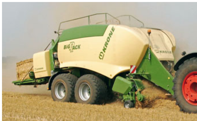
Die „Active“-Pickup mit der mechanisch angetriebenen Zuführwalze kennen wir schon von der „HighSpeed“. Die 16-t-Achse erlaubt Reifen bis zur Größe 710/45-26.5. Dann ist die 15,8 t schwere Presse allerdings 3,19 m breit.
