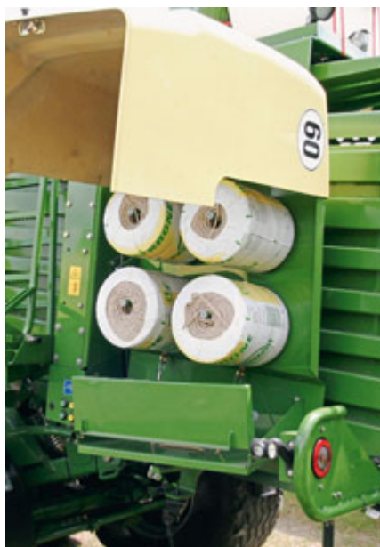
Wahlweise gibt es noch Platz für 2 x 6 Rollen hinten am Presskanal.
