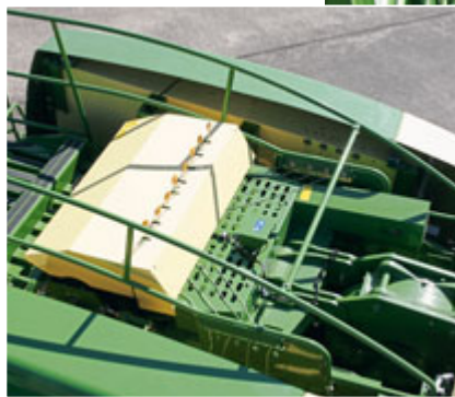
Die 8 Rassepe-Doppelknoter wurden komplett neu entwickelt und sind 5 cm schmalere. Auf Wunsch sorgen zwei mechanisch angetriebene Radialgebläse zusätzlich zur Druckluftreinigung für mehr Bindsicherheit.
