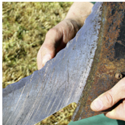
Ein stumpfes Messer nach ungefähr 10 Einsatzstunden im Ladewagen.
