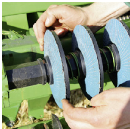
Die Fächerscheiben sind federnd auf einer Welle gelagert.
